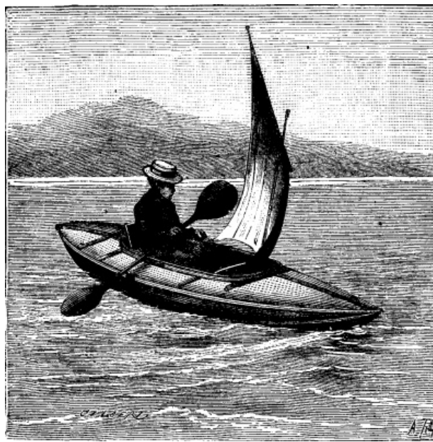
FIG. 1.--BERTHON COLLAPSIBLE CANOE AFLOAT.
