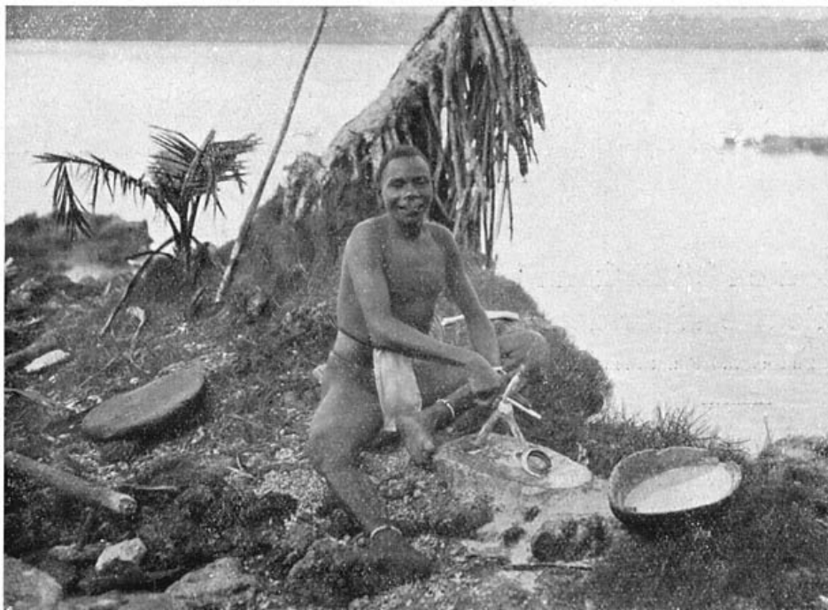
Vervaardiging der Trochusarmringen. De ring wordt uit een schelp uitgeklopt en dan met een stuk koraal geslepen.
