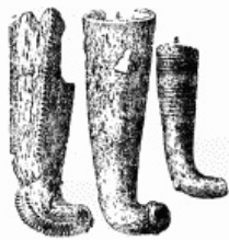
Fig. 65.—Tuyères de fours métallurgiques.—1, Silésie.—2-3, Hongrie. (agrandir)
