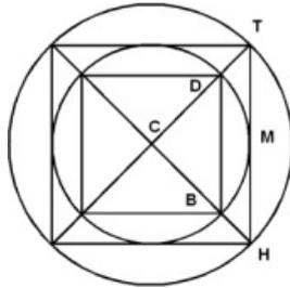
Um um<sup>1</sup> einen Kreis ein regelmässiges Viereck zu beschreiben, dessen Seiten mit denen des eingeschriebenen parallel sind, halbiere<sup>2</sup> man einen Bogen in M, ziehe durch M eine Tangente, welche die verlängerten Radien CB, CD in T und H schneidet, dann ist HT eine Seite des umschriebenen Vierecks, welche man nur in dem mit CT als Halbmesser beschriebenen zweiten Kreise herumzutragen<sup>3</sup> braucht.
