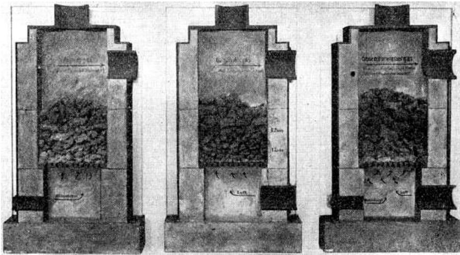
Abb. 16. Entstehung von Wassergas, Generatorengas und Generatorenwassergas.
