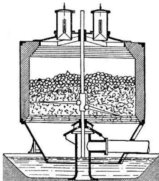
Abb. 17. Gasgenerator.
