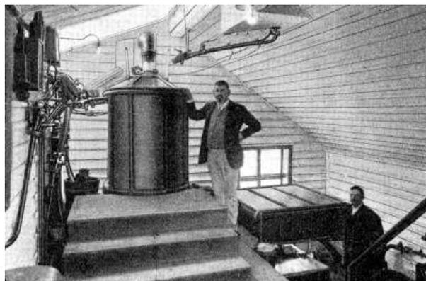
Abb. 19. Apparat zur Herstellung von Dynamit.
