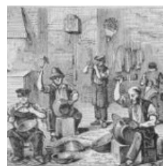
CHAUDRONNERIE D'AURILLAC.—La chaudronnerie est l'art de fabriquer tous les ustensiles en métal qui servent à faire chauffer l'eau et les aliments. La petite chaudronnerie fabrique les chaudrons de cuisine, les casseroles, les poêlons, etc. La grosse chaudronnerie fabrique les énormes chaudières des
