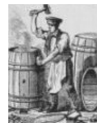
LE TONNELIER.—Pour rendre plus flexibles les douves qu'il veut recourber et assembler, le tonnelier allume dessous un feu de copeaux. Ensuite il les entoure de cercles en bois ou en fer.
