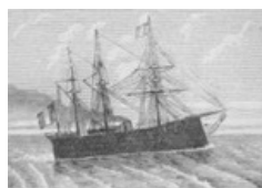
UN VAISSEAU CUIRASSÉ.—On appelle de ce nom des vaisseaux tout entourés d'une épaisse cuirasse de fer sur laquelle les boulets glissent sans pouvoir s'enfoncer: ce sont comme des forteresses flottant sur l'eau. Les vaisseaux de
