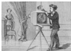
LA BOÎTE DES PHOTOGRAPHES.—C'est une boîte fermée de tous côtés, où la lumière n'entre que par un petit tube . L'image des objets placés devant la boîte se projette sur le fond, mais renversée. Le photographe introduit au fond de la boîte une plaque qui a la propriété de noircir à la lumière; il laisse ensuite pénétrer un rayon lumineux, et bientôt les objets se trouvent dessinés sur la plaque. C'est comme si on parvenait à fixer sur un miroir l'image de celui qui
