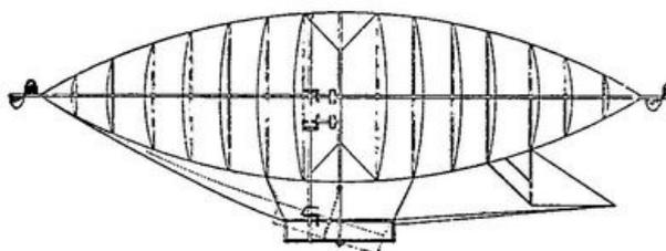
Fig. 76.—Projet d'aérostat en aluminium de Micciollo-Picasse (1871).
