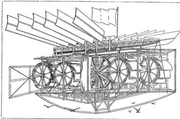
Fig. 80.—Propulseur aérostatique de Ziegler (1868).
