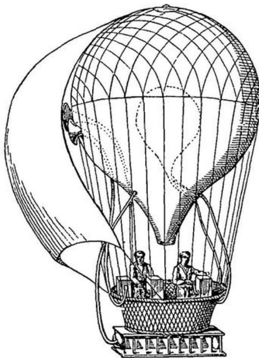
Fig. 56.—Voile de direction d'un ballon gonflée par un ventilateur.
