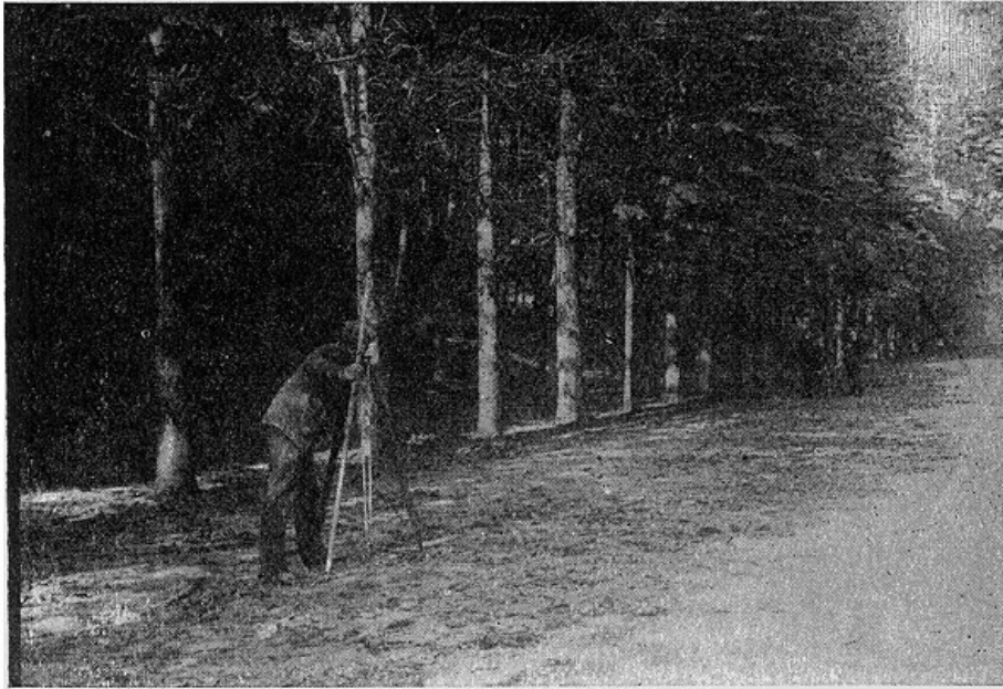
Mesure des bases à l'aide des fils de métal invar. Alignement des repères mobiles.
