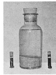
Les explosifs: dans les tubes, l'acide sulfurique; au fond du flacon, le fulminate de mercure, noyé dans l'eau.
