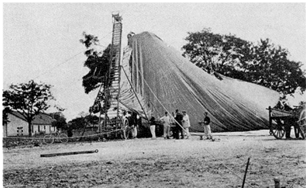
L'enveloppe du dirigeable Lebaudy , éventrée par la tempête au camp de Châlons, le 6 juillet.
