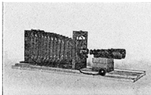
Dispositif pour photographier à grande distance.
