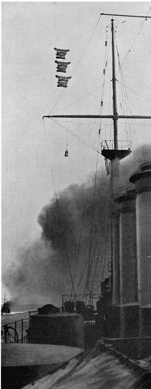
**Le lancement d'un cerf-volant monté, à bord du croiseur *Edgar-Quinet*.**
