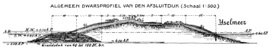
ALGEMEEN DWARSPROFIEL VAN DEN AFSLUITDIJK (Schaal 1:500.)
