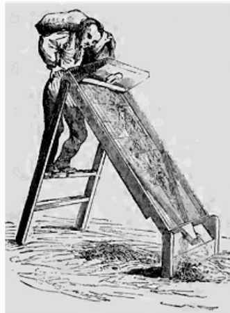
Crible à plan incliné, par M. Quentin-Durand.
