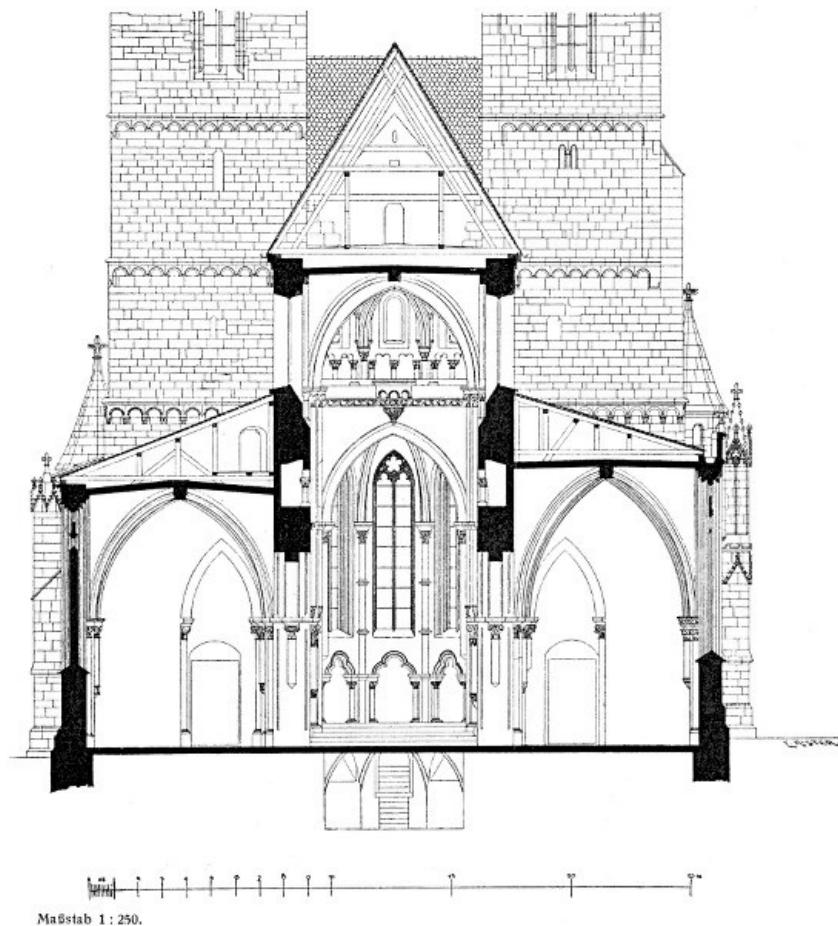
Abb. 19. Querschnitt durch das Mittelschiff und die Seitenschiffe.
