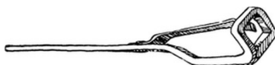
Fig. 40. Mit Feder versehener Kopf eines Bräter-Bratspießes aus der Küche des Museums.
