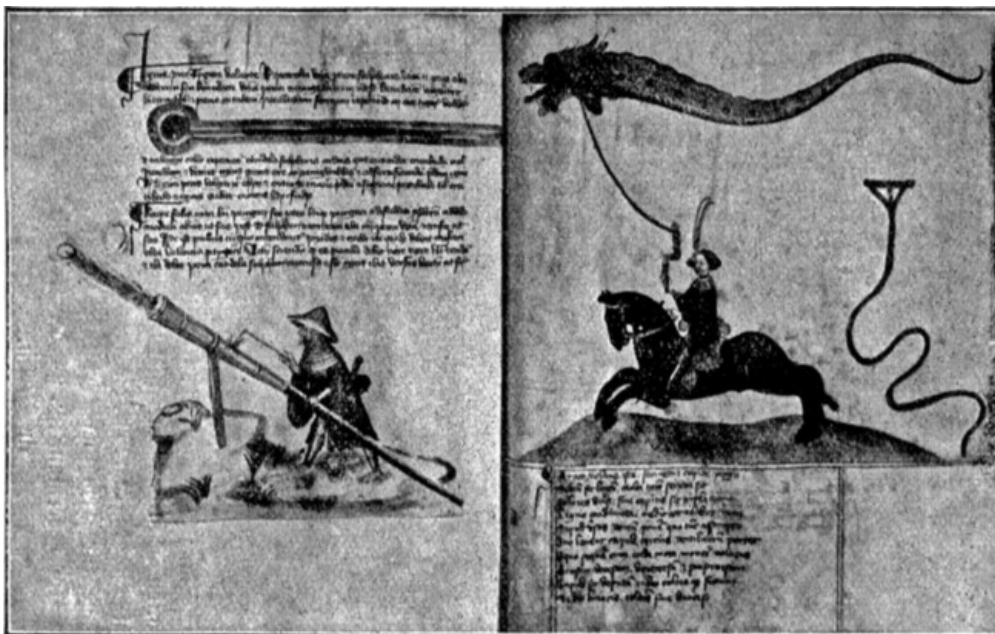
Zwei Seiten aus der kriegstechnischen Handschrift des Ingenieurs Konrad Kyeser von Eichstätt aus dem Jahr 1405. Rechts der Drachenballon am Fesselseil. Links oben die Petroleumlampe zum Drachenballon. Unten ein Krieger, der eine Büchse mittels des Gluteisens abschießt.
